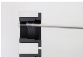
Kettős tapintó fent-lent tapintáshoz
